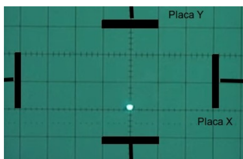
Haz de electrones controlado por dos campos electrostáticos perpendiculares.
